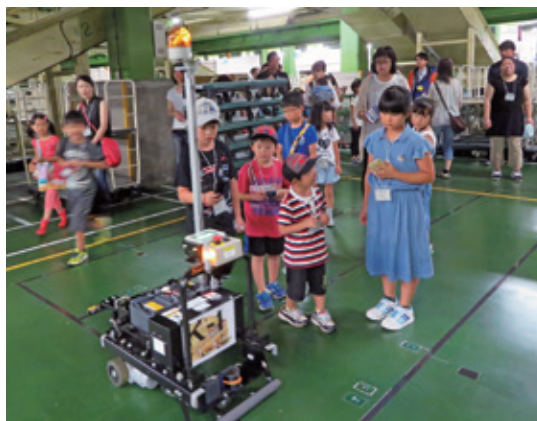
設定したコースを通り、台車を自動搬送するシステム（キーカート）の後をついて歩く
